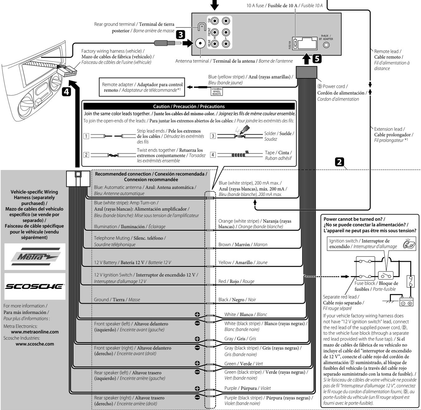
**Vehicle-specific Wiring Harness (separately purchased) / Mazo de cables del vehículo específico (se vende por separado) / Faisceau de câble spécifique pour le véhicule (vendu séparément)**
