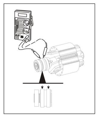
FIGURE 18. WINDING RESISTANCE TEST
