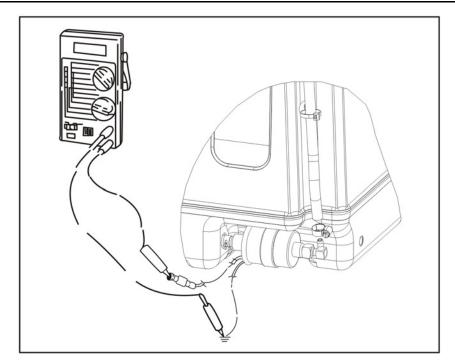
FIGURE 29. FUEL PUMP TEST
