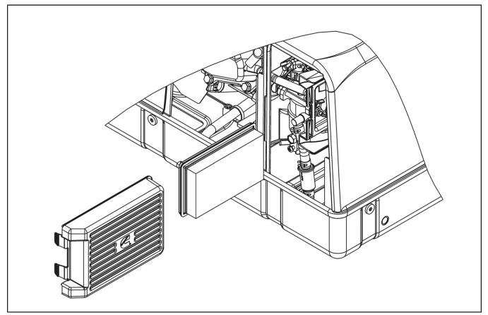
FIGURE 24. AIR FILTER ASSEMBLY
