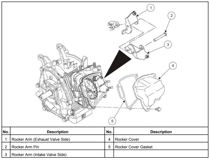
FIGURE 43. ROCKER COVER AND ROCKER ARM
