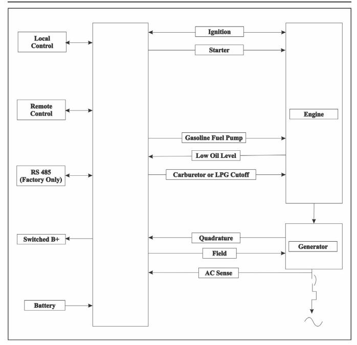
FIGURE 6. CONTROLLER BLOCK DIAGRAM
