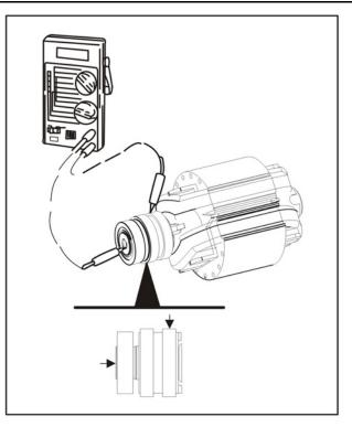
FIGURE 17. GROUNDED ROTOR TEST
