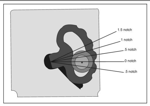
FIGURE 26. CHOKE ADJUST
