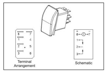
FIGURE 8. CONTROL SWITCH S1
